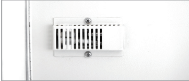
箱内温度传感器相对固定并且外加防护罩，避免与箱体或者存储物品接触导致监测失真；
